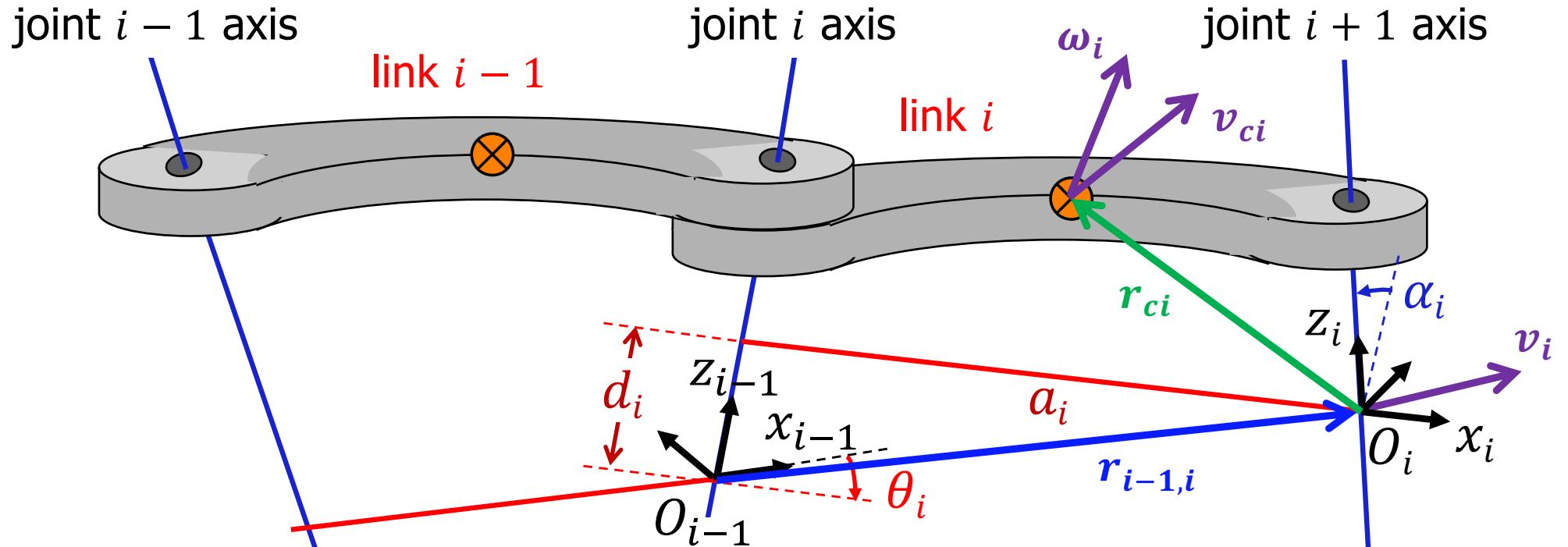
$$i^{-1}A_i(q_i) = \begin{pmatrix} \cos \theta_i & -\cos \alpha_i \sin \theta_i & \sin \alpha_i \sin \theta_i & a_i \cos \theta_i \\ \sin \theta_i & \cos \alpha_i \cos \theta_i & -\sin \alpha_i \cos \theta_i & a_i \sin \theta_i \\ 0 & \sin \alpha_i & \cos \alpha_i & d_i \\ 0 & 0 & 0 & 1 \end{pmatrix}$$
