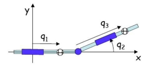
Definite le coordinate generalizzate come in figura, si calcola l'energia cinetica dei due corpi costituenti il robot. Si può trascurare la massa della parte fissa a valle del giunto rotatorio. Si ha:
