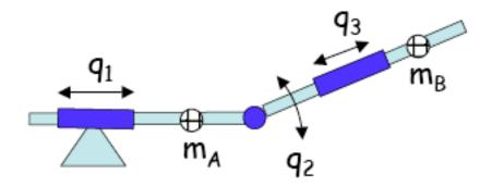
Si ricavi il modello dinamico del robot PRP mostrato in figura, in moto in un piano verticale. Si indichino esplicitamente le assunzioni fatte nella modellizzazione.
