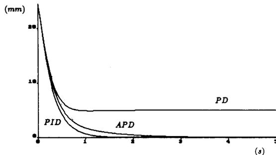
Fig. 3. End effector error: nominal payload  $\neq$  actual payload, initial error = 24 mm.
