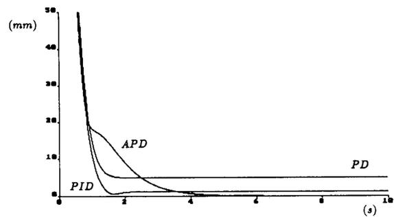
Fig. 4. End effector error: nominal payload  $\neq$  actual payload, initial error = 412 mm.
