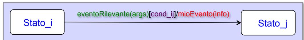
Progettazione del Software - Diagrammi degli stati e delle transizioni
