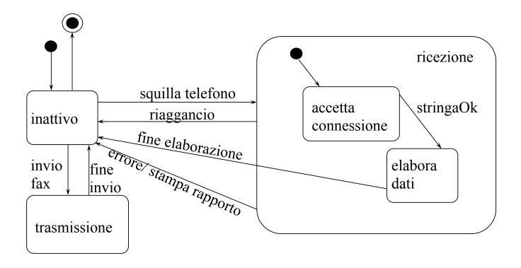
Progettazione del Software - Diagrammi degli stati e delle transizioni
