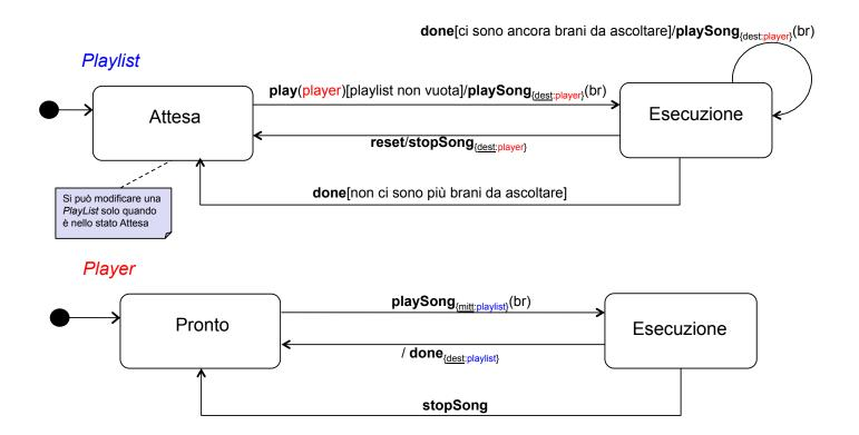
Progettazione del Software - Diagrammi degli stati e delle transizioni
