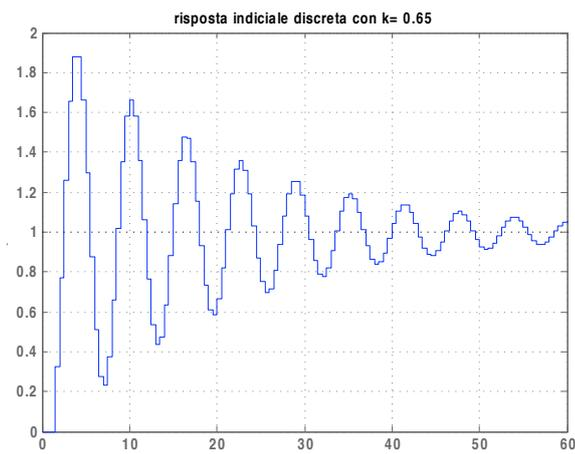
Figura 3: Risposte indiciali del sistema discreto ad anello chiuso per  $k = 0.05$ ,  $k = 0.35$  e  $k = 0.65$
