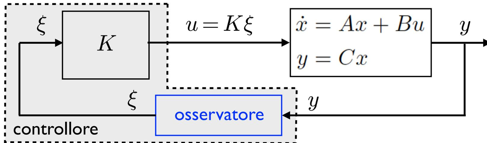
dove l'**osservatore** è un dispositivo che produce una **stima  $\xi$  dello stato  $x$**  a partire dalla misura dell'uscita
