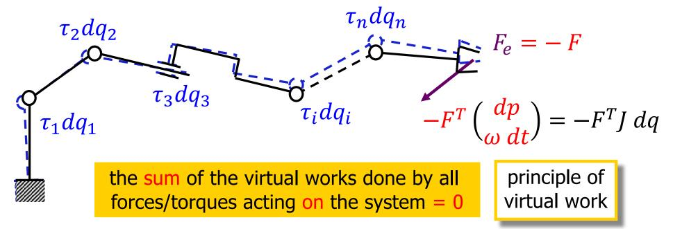
$$\tau^{T}dq - F^{T}\begin{pmatrix} dp \\ \omega dt \end{pmatrix} = \tau^{T}dq - F^{T}Jdq = 0 \quad \forall dq$$
