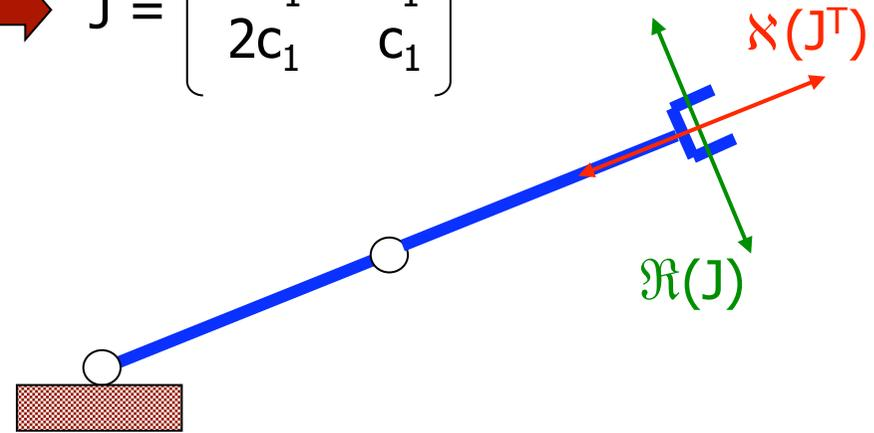
singularità braccio ripiegato ( $q_2=\pi$ )  $\Rightarrow J = \begin{bmatrix} 0 & s_1 \\ 0 & c_1 \end{bmatrix}$
