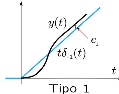
Il concetto di Tipo di Sistema può essere specificato per i sistemi a retroazione: si individuano le condizioni affinché un sistema di controllo a retroazione sia di tipo  $k$ .
