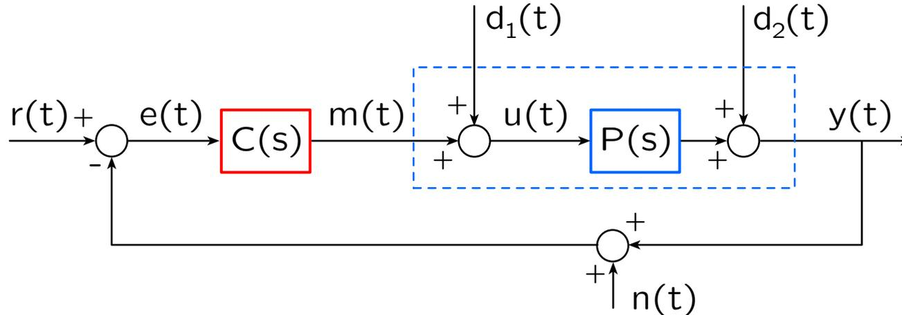
nel quale, ad esempio, si è distinto tra disturbi in ingresso  $d_1(t)$  e in uscita  $d_2(t)$  al processo.
