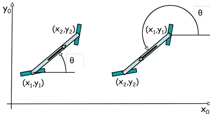
Figura 1: Definizione dell'orientamento  $\theta$  dell'asse longitudinale del veicolo
