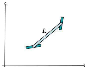
La figura rappresenta schematicamente un robot mobile con due ruote, entrambe ad orientamento variabile, poste ad una distanza  $L$  (lunghezza del veicolo). Scelte le variabili di configurazione ed espressi in termini di esse i vincoli di puro rotolamento delle due ruote, ricavare un modello cinematico nella forma  $\dot{q} = G(q)u$  che descriva (nello spazio delle configurazioni) tutti i moti istantanei ammissibili del veicolo.
