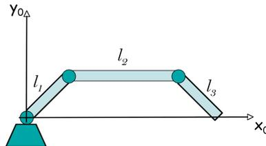
Si consideri il robot planare a tre giunti rotatori nella configurazione mostrata in figura. Le lunghezze dei bracci sono
