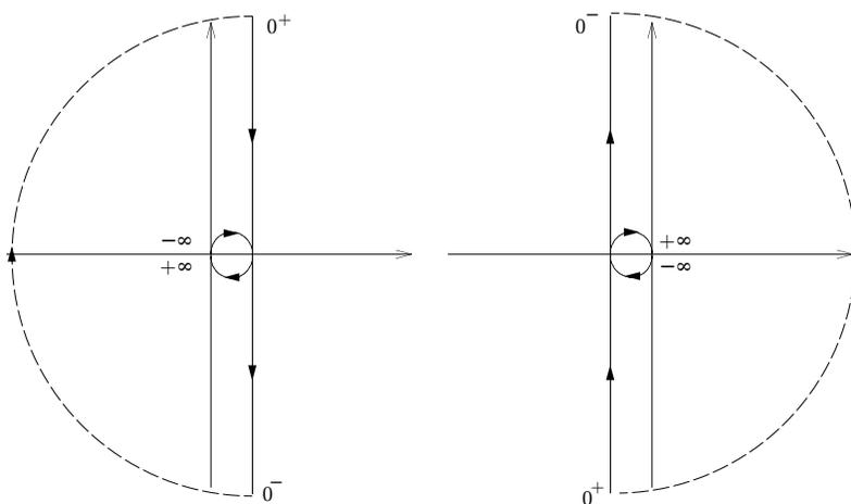
Se ne deduce che il sistema retroazionato è instabile per  $k > 0$ , è stabile asintoticamente per  $k^* < k < 0$ , ed è ancora instabile per  $k < k^*$ . Essendo inoltre il denominatore della funzione di trasferimento ad anello chiuso pari a
