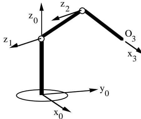
Individuare una base per lo spazio delle velocità cartesiane ammissibili ed una per lo spazio delle forze cartesiane bilanciate da coppie nulle ai giunti, in corrispondenza alla configurazione:
