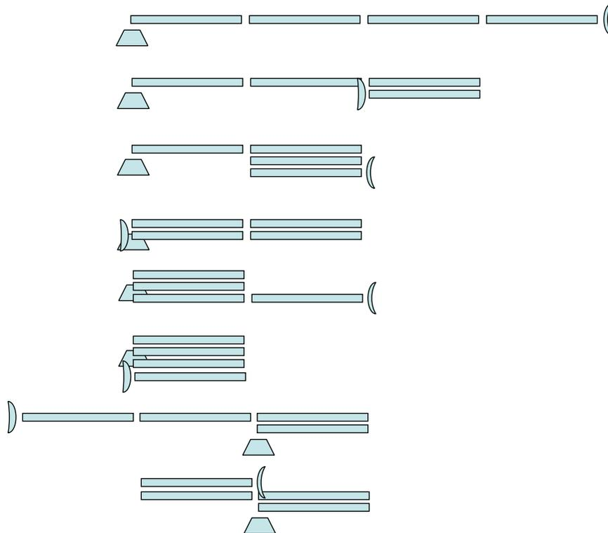
Nel primo tipo di singolarità l'organo terminale si trova a distanza 4 dall'origine, al confine dello spazio di lavoro. Tale singolarità è l'unica inevitabile. Nel secondo, terzo, quinto e settimo tipo di singolarità l'organo terminale si trova a distanza 2 dall'origine. Infine, nel quarto, sesto e ottavo tipo di singolarità l'organo terminale si trova nell'origine. Pertanto il luogo dei punti cartesiani per l'organo
