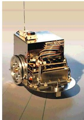
Con riferimento alla figura seguente, sia  $r = 0.2$  [m] il raggio delle due ruote e  $d = 0.2$  [m] la lunghezza del semiasse delle ruote. Le coordinate del punto centrale dell'asse delle ruote nella terna assoluta  $(X, Y)$  sono  $(x, y)$  e l'orientamento del veicolo è individuato da un angolo  $\theta$  rispetto all'asse  $X$ .
