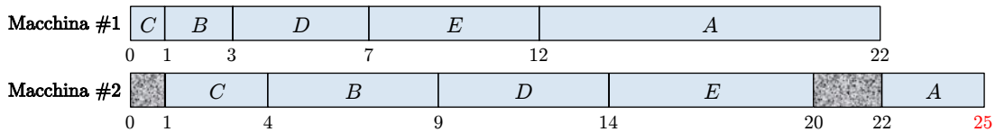
Figura 4: Diagramma di Gantt con la soluzione del problema di flow shop scheduling.
