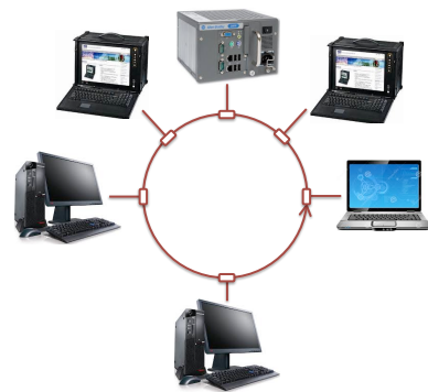
Una rete di comunicazione tra workstation, notebook e PC industriali connessi ad anello con protocollo Token Ring
